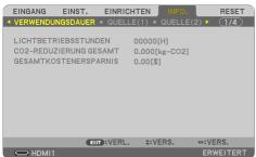
Die Meldung [CO2-REDUZIERUNG-SESSION] zeigt die Menge der  $CO_2$ -Emissionsreduktion in der Zeit zwischen dem Wechsel in die ECO-BETRIEBSART sofort nach dem Einschalten und dem Zeitpunkt des Ausschaltens an. Die Meldung [CO2-REDUZIERUNG-SESSION] wird in der Meldung [STROM AUSSCHALTEN/SIND SIE SICHER?] beim Ausschalten angezeigt.
