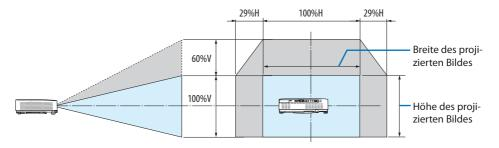
Beschreibung der Symbole: V bedeutet vertikal (Höhe des projizierten Bildes), H bedeutet horizontal (Breite des projizierten Bildes).
