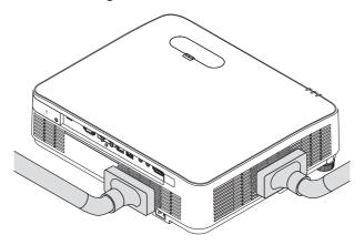
Saugen Sie den Staub von den Lüftungsschlitzen oder dem Lautsprecher ab.
