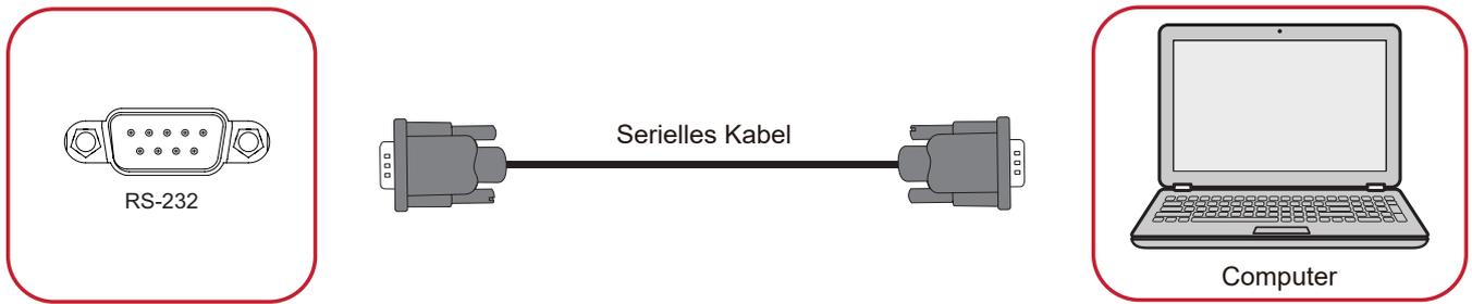
Wenn Sie Ihr Display über ein seriellles RS-232-Kabel mit einem externen Computer verbinden, können Sie bestimmte Funktionen per PC fernsteuern – beispielsweise Ein-/Ausstellen, Lautstärkeregelung, Eingangsauswahl, Helligkeit und mehr.
