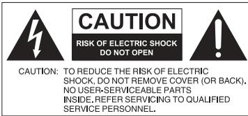
Das Symbol eines Blitzes mit Pfeilspitze innerhalb eines gleichseitigen Dreiecks soll den Benutzer auf das Vorhandensein von unisolierter "gefährlicher Spannung" innerhalb des Produktgehäuses hinweisen, welche groß genug sein kann, um die Gefahr eines Stromschlages für Personen darstellen zu können.
