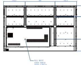
5. Bringen Sie die Wandhalterung am Bildschirm an und befestigen Sie den Bildschirm gemäß der Anweisung für die Halterung an der Wand. Die Länge der Schraube sollte die Dicke der Wandhalterung um mindestens 25 mm überschreiten. Stellen Sie sicher, dass alle Schrauben richtig angezogen werden. (Empfohlenes Drehmoment: 470 - 635N•cm). Die Montagefläche muss stabil genug sein, das Gewicht des Bildschirms zu tragen.
