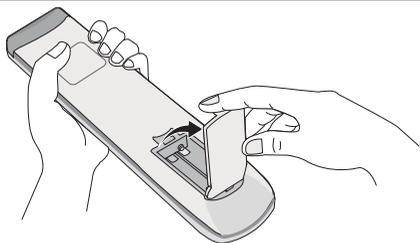
1. Öffnen Sie die Batteriefachabdeckung der Fernbedienung.
