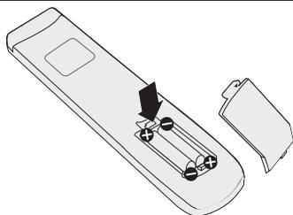
2. Legen Sie die beiliegenden Batterien ein und stellen Sie sicher, dass die als positiv und negativ markierten Batteriepole den (+) und (-) Zeichen im Batteriefach entsprechen.
