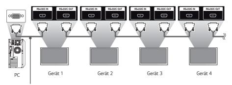
RS-232C-Kabel (separat erhältlich)
