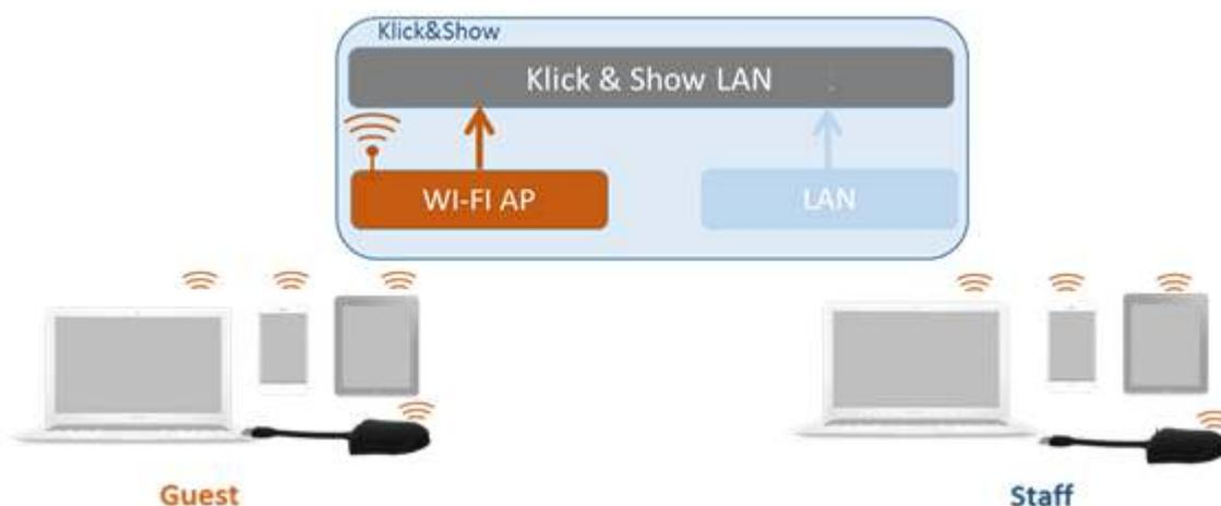
Bevor Mitarbeiter Informationen von einem PC (ohne Dongle) oder einem mobilen Gerät zu Klick & Show übertragen können, müssen sie ihr Gerät mit dem WLAN-Netzwerk von Klick & Show verbinden. Dies kann von
