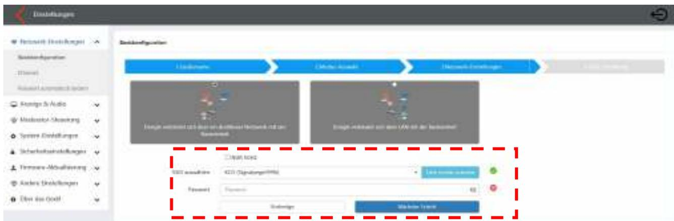
Wählen Sie zuerst ob die Basis per WLAN oder per LAN in das bestehende Netzwerk eingebunden werden soll. Falls ein 2,4GHz Netzwerk genutzt werden soll, deaktivieren Sie bitte die Checkbox bei „NUR 5GHz“.
