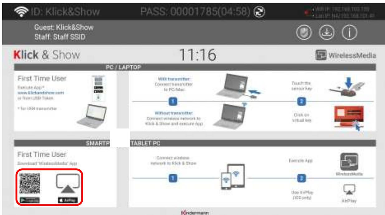
Bei der ersten Inbetriebnahme **oder** nach dem Zurücksetzen auf die Werkseinstellungen startet Klick & Show in der **Standardkonfiguration "Wireless Direct Mode"** ("Linked-Single Network"), bei der die Basiseinheit einen eigenen drahtlosen Zugangspunkt erstellt, mit dem sich alle Dongle verbinden. Dies ist typisch für eine schnelle Einrichtung für Meetings in kleineren Firmen mit wenigen Konferenzräumen oder bei vorübergehender Installation.
