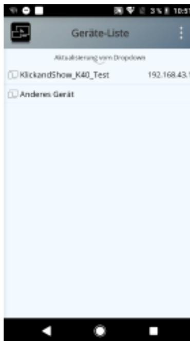
**Geräteliste (Device List):** zeigt die verfügbaren Klick & Show Basis-Geräte an, um Ihr Mobilgerät damit zu verbinden. *(Hinweis: Die Mobilgeräte müssen zuerst mit dem Klick & Show WLAN verbunden werden).*
