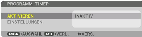
Diese Option schaltet den Projektor ein/in Standby, ändert Videosignale und wählt die LICHT-Betriebsart automatisch zu einer festgelegten Zeit.
