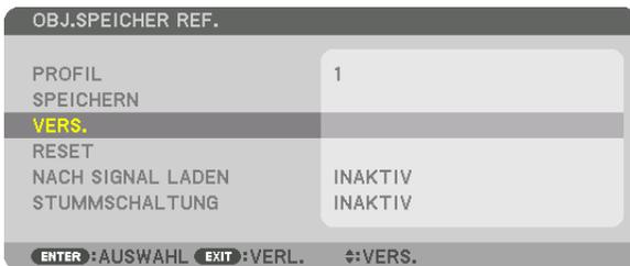
Das Objektiv wird gemäß den eingestellten Werten im ausgewählten [PROFIL] verschoben.
