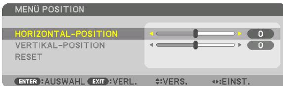
**5. Bewegen Sie den Cursor entweder zu [HORIZONTALE POSITION] oder [VERTIKALE POSITION], indem Sie die ▼ oder ▲-Taste drücken und drücken Sie dann die ◀/▶-Taste, um das Bildschirmmenü zu verschieben.**
