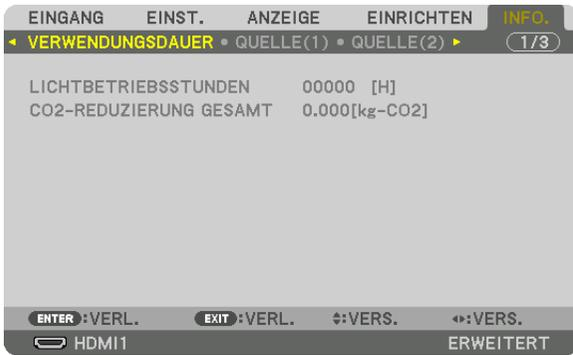
Die Meldung [CO<sub>2</sub>-REDUZIERUNGS-SESSION] zeigt die Menge der CO<sub>2</sub>-Emissionsreduktion in der Zeit zwischen dem Wechsel in die LICHTBETRIEBSART sofort nach dem Einschalten und dem Zeitpunkt des Ausschaltens an. Die Meldung [CO<sub>2</sub>-REDUZIERUNGS-SESSION] wird in der Meldung [NETZSTROM AUSSCHALTEN/SIND SIE SICHER?] beim Ausschalten angezeigt.
