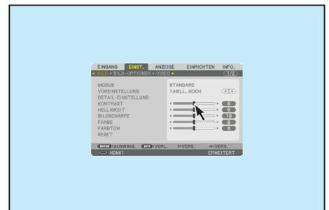
3. Wählen Sie die [BEENDEN]-Anzeige unten im Menü mit Linksklick, um zum vorherigen Level zurück zu gehen. Wenn sich der Cursor in der Hauptmenü-Option befindet, funktioniert er zum Schließen des Menüs. (Er funktioniert auf gleiche Weise wie die [EXIT]-Taste auf der Fernbedienung.)
